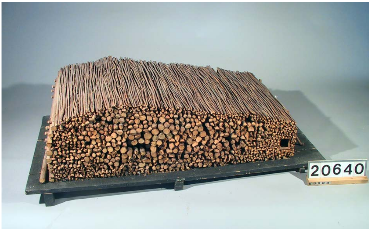
Figur 3. Liggmila av Norbergstyp, för träkolning, skalmodell. Foto och källa: Tekniska museet, bildid: TEKS0022276 (CC BY).
