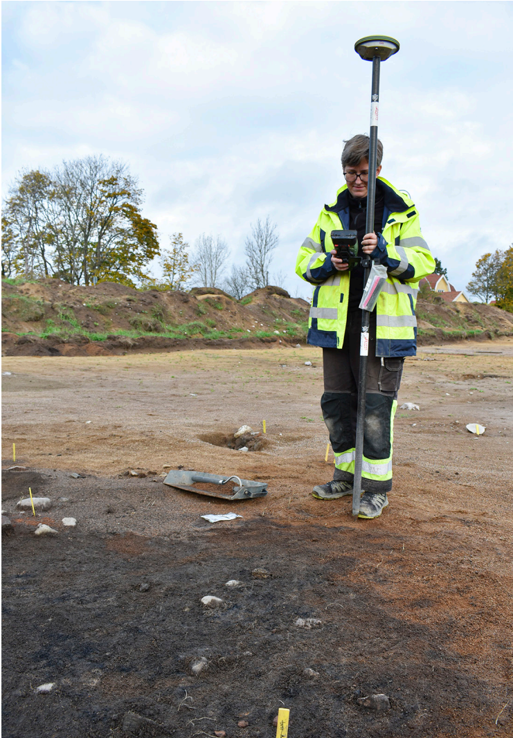
Figur 29. Alla mörkfärgningar, anläggningar och lager mättes in av en arkeolog med en GPS-station. Inmätningarna förs därefter över till ett datorprogram där vi på en karta kan plotta ut allt som mätts in. På bilden ser vi hur arkeolog Amanda Jönsson är i färd med att mäta in en anläggning.
