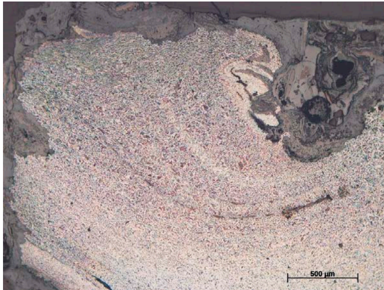
Figur 17. Kniven 786:13093:2. Detalj (roterad) från övre rutan i figur 13 på etsat prov. Här ses flera ljusare/mörkare band med finkornigare textur jämfört med i föregående figur. Banden, med något lägre/högre kolhalter böjer av längs med de tunna grå slaggineslutningarna. Överst till höger ses en grå rostfläck.
