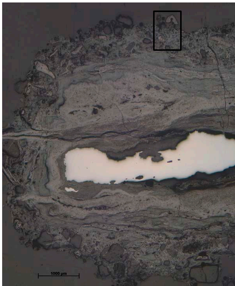
Figur 7. Järnavfallet 786:13094 (5). Foto från mikroskopet på övre delen av provet i figur 6 (vänd 90 grader). Det vita järnet är omgivet av grå rost med fastkittat material (Se detalj från rutan i nästa figur).
