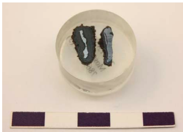
Figur 6. Polerprov på tvärsnitt från en av de magnetiska klumparna i 786:13094 (5) till vänster och kniven 786:13093:2 till höger.
