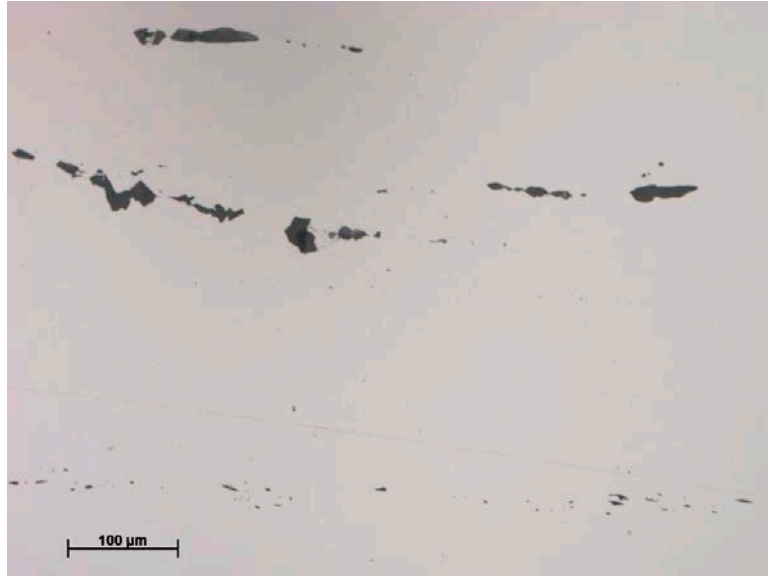
Figur 9. Järnavfallet 786:13094 (5). Foto från mikroskopet på detalj på två långsträckta stråk av grå slagginnestutningar i det ljusa järnet. I övre delen mörkare grå inneslutningar av en glasfas som är rik på kisel. I nedre delen mindre inneslutningar som är ljusare grå och rikare på järnoxid.
