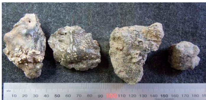
Fig.8. Fragment av delvis förglasad ässjefodring från L1980:1727 (FK 736:12973).
