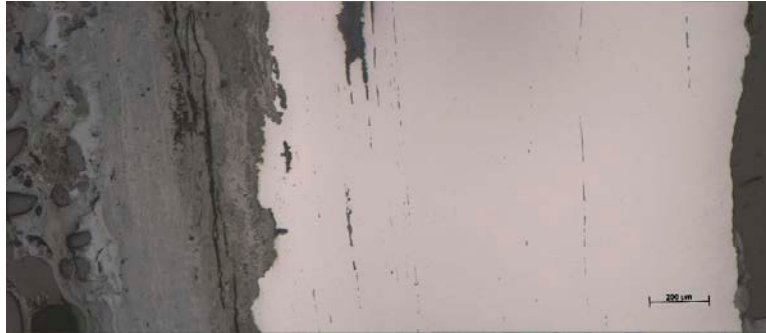
Figur 14. Kniven 786:13093:2. Foto från mikroskopet. Detalj genom centrala delar på polerat prov. Längst till vänster den grå rosten med fastkittat material. I metallen till höger ses flera mörka stråk av slagginneslutningar (Se följande figurer).
