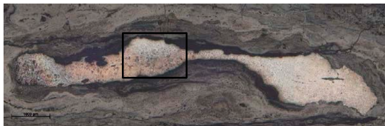
Figur 10. Järnavfallet 786:13094 (5). Översiktsfoto från mikroskopet på etsat prov. Metallen är brun- och blåfärgad av etsningen – starkare färg (t.ex. i vänstra delen) antyder högre kolhalt (Se detalj i följande figur).
