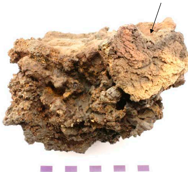
Figur 18. Slagg 796:21238 med plan och slät överyta och med oregelbundet formad botten. I övre högra delen ses ett fragment av rödbränd lera som är hopsmält med slaggen. Längs överkanten av lerfragmentet, i nivå med slaggens överyta finns en halvcirkelformad fördjupning (halvt hål, se pilen), troligen ett blästerhål.
