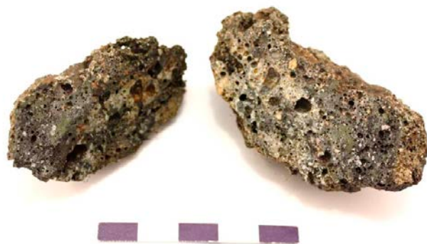
Figur 4. En av de oregelbundna slaggluknande klumparna från 786:13094 (3) som mest är smält sand. I delat snitt ses glasigt material, lite slagg, och rikligt med osmälta kvartskorn.
