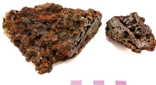
Figur 3. Den större slaggen från 786:13094 (2) som är yttre delen av en skälla. I det delade tvärsnittet ses slagg som är homogen i sammansättning men skiktad med avseende på porositet där de större porerna finns i slaggens övre, mer trögflutna del.
