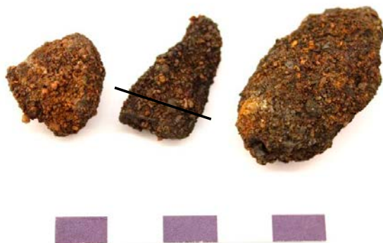
Figur 5. Magnetiska klumpar från 786:13094 (5). Biten i mitten är delad längs linjen och analyserad. Se också polerprovet i figur 6.
