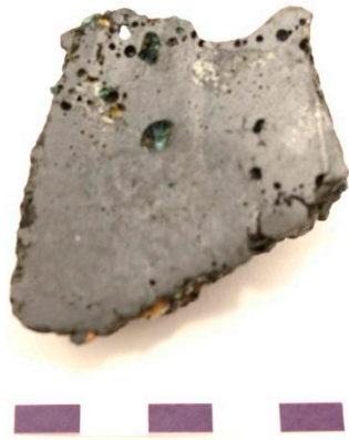
Figur 5. En av bitarna från figur 2 med ärggrön beläggning, som i tvärsnitt visar en homogen slagg.
