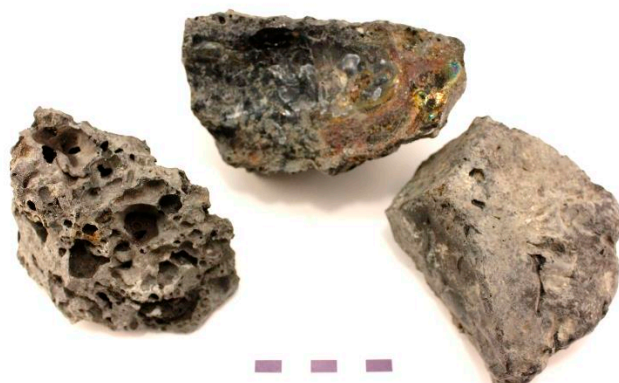
Figur 3. Urval av slagger från den centrala delen av det undersökta området, i mitten med oljig yta.
