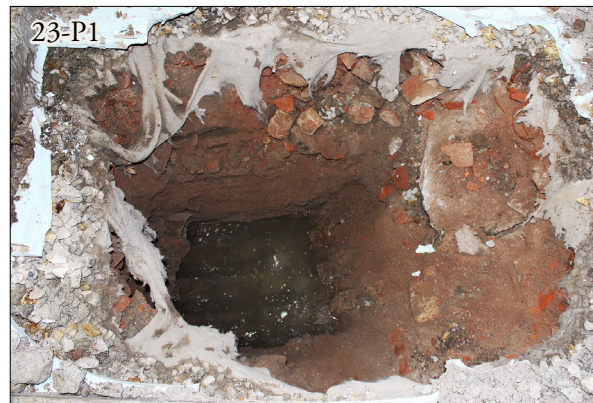
Figur 15. Bottendjup i provgrop 23-P1. Vatten framkom på ett djup av 1,2 meter under befintlig golvnivå. Fotografi taget från syd sydväst.
