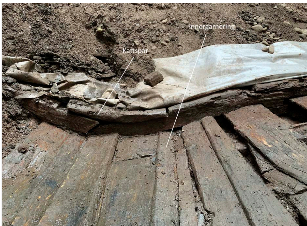
Figur 1. Kattspåret (förstärkande intimmer) visar skeppets form från botten upp emot slaget. Kattspåren hade som funktion att avlasta de stora tyngderna som batteridäcken utgjorde och på så sätt minska belastningen på skrovet konstruktion. Notera även till vänster i bild hur kattspåret är ursparat mellan innergarneringen där en smalare plank legat. Foto: Jim Hansson, SMTM.
