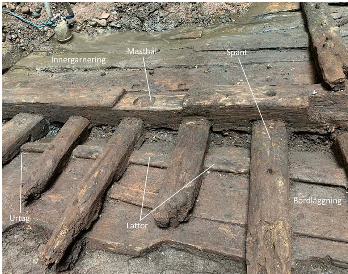
Figur 2. Lattorna syns tydligt in situ liggandes mot insidan av bordläggningen under spanten. På spantet till vänster i bild kan man se urtaget för lattorna. Notera även masthålet på kölsvinets ovasida. På hitsidan om kölsvinet syns konstruktionen på skrovet väl. På andra sidan täcks den av innergärning. Foto: Jim Hansson, SMTM.
