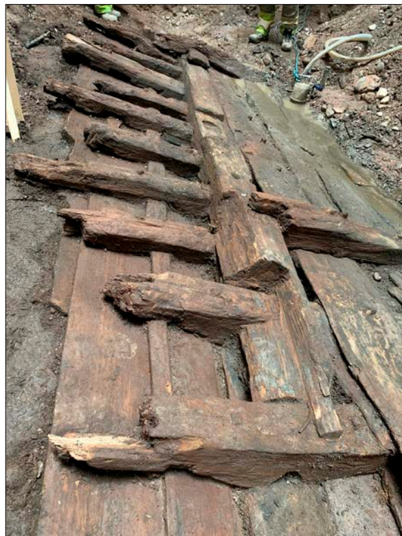
Figur 5. På kölsvinet syns ett tydligt snitt där man sågat/huggit. Spår som sannolikt tillkom vid upphuggningen av fartyget. Foto: Jim Hansson, SMTM.
