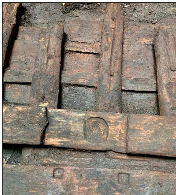
Figur 3. Masthållet hade en märklig form. Ett rektangulärt urtag med en rundad försänkning syns på kölsvinets ovsida. Två mindre rektangulära urtag syns på innergameringen. Sannolikt har det även funnits på andra sidan av kölsvinet. Detta är troligen stöttor för högre liggande balkar som stöttat masten. Foto: Jim Hansson, SMTM.
