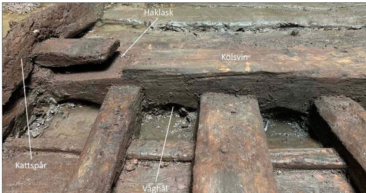
Figur 4. De välvda våghålen syns tydligt och ser ut att vara gjorda med stor omsorg. Kölsvinet har en fin håklask till vänster i bild med ett kattspår ovanpå. Foto: Jim Hansson, SMTM.
