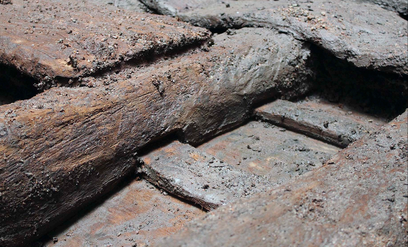
Figur 16. Detaljbild över konstruktionselement i vraket. Notera hur de så kallade "lattorna", rektangulära små klossar, är infästa under spanten. Lattornas funktion var att hålla drevet i nåten mellan bordplankorna på plats.
